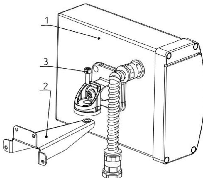
1 – блок ПРМ-ПРД; 2 – Кронштейн-120М; 3 – винт М5
