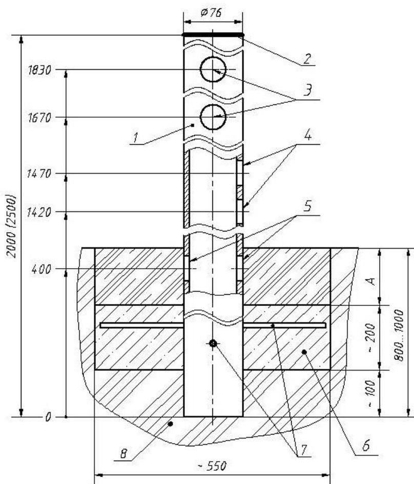
1 - «ОПОРА-2» или «ОПОРА-2,5»; 2 - заглушка пластмассовая; 3 - отверстия для ввода кабеля извещателя внутрь опоры; 4 - отверстия для ввода магистрального кабеля и кабеля извещателя; 5 - отверстия для ввода магистрального кабеля; 6 - бетон (гравий); 7 - штыри для предотвращения несанкционированного демонтажа опоры; 8 - грунт.
