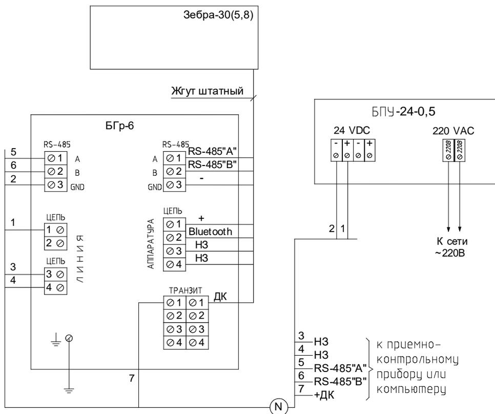
Рисунок - 2.5 Схема подключения извещателя при использовании блока грозозащиты «БГр-6» (Bluetooth не активен)
